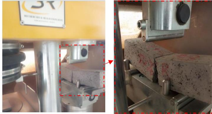
Figure II. 21: Presse 3R pour essais de compression et de flexion 3 points au L2MGC
