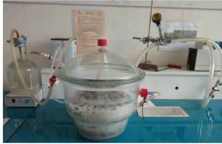
Figure II. 22: Appareillage de mesure de la porosité à l'eau sous vide (L2MGC).
