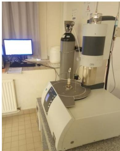
Figure II. 29: Appareil ATG/ DSC NETZSCH STA 449 F1 Jupiter au L2MGC
