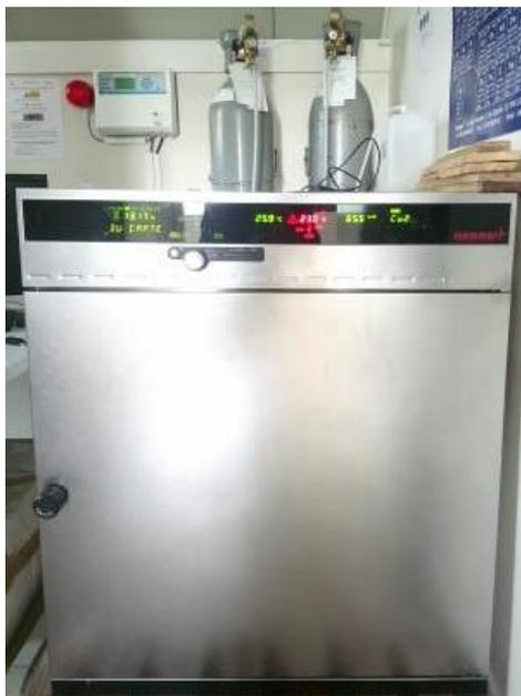
Figure II. 24: Présentation de l'enceinte de carbonatation accélérée au L2MGC
