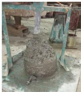
Figure II. 15 : Mesure de l'affaissement au cône d'Abrams au LMMSP
