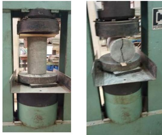
Figure II. 17 : Appareil d'essai de réalisation de la compression et de la traction par fendage au LMMS
