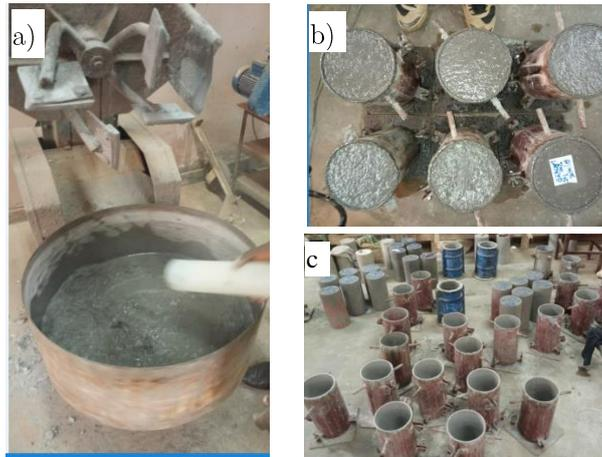
Figure II. 12 : Malaxeur (a), confection des éprouvettes (b), démoulage des éprouvettes (c) au LMMSP (Campagne 1)
