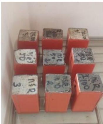
Figure II. 26 : Image de réalisation des essais de capillarité des échantillons de mortier
