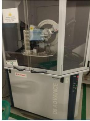
Figure II. 10: vue d'ensemble du dispositif d'analyse DRX de chez Bruker AXS D8 au laboratoire SRO
