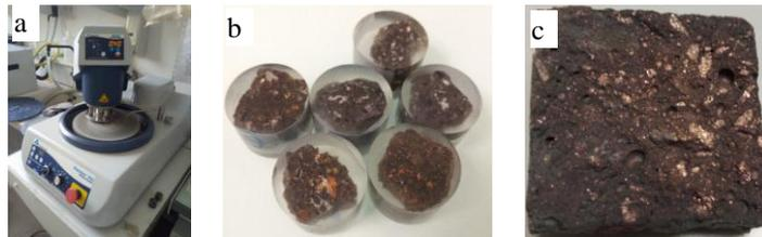
Figure II. 28 : Polisseuse semi-automatique (a) et échantillons imprégnés de résine et polis (b) échantillons métallisés (c) au L2MGC
