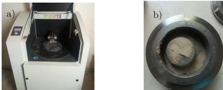
Figure II. 7 : Vibro-broyeur RETZSCH Mill RS 200 : Emplacement du bol de broyage (a) ; Garniture en tungstène contenant un échantillon de sable réduit en poudre après broyage (b) au L2MGC
