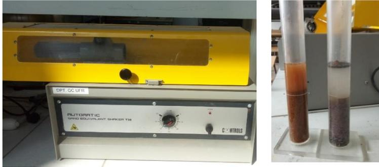
Figure II. 11: Image de la réalisation de l'essai d'équivalent de sable au L2MGC.
