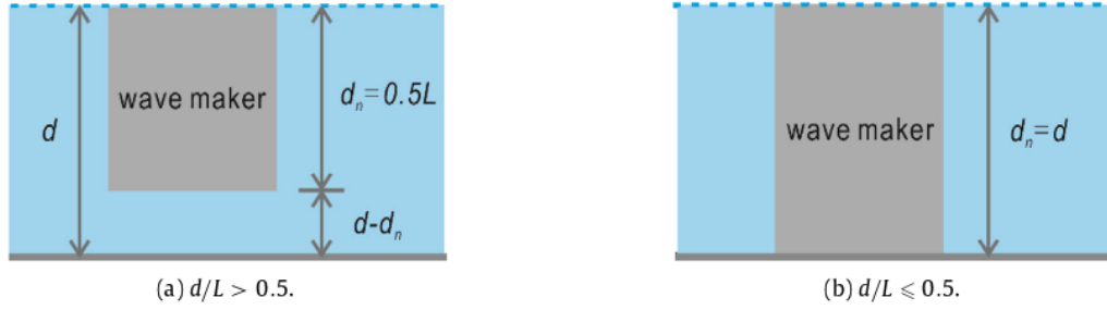
Fig 3.7 Emplacement du générateur du train de vagues pour différentes profondeurs d'eau [Wen et Ren, 2018].
