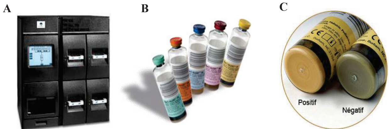
Figure 3 : A : BacT ALERT 3D, B: Bouteille d'hémoculture du BacT ALERT 3D et C : Changement de couleur du capteur lors d'une modification du pH (75)
