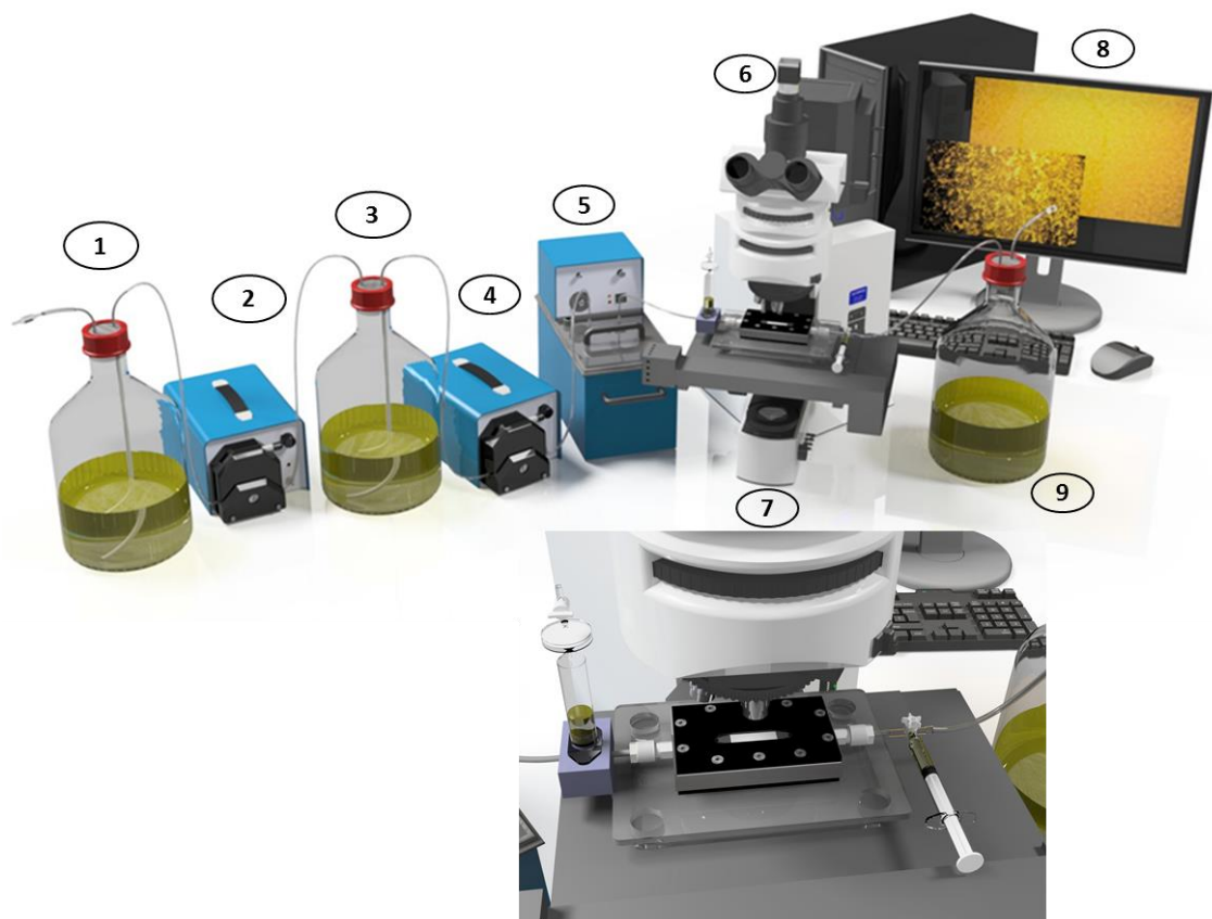
Figure 20 : Schéma du dispositif expérimental pour l'étude des biofilms de L. lactis en conditions d'écoulement. (1) et (3) : réservoirs de stockage du milieu de culture avec leurs pompes respectives (2) et (4). (5) : bain-marie dans lequel baigne le tuyau d'alimentation. (6) : microscope à fluorescence avec caméra. (10) : chambre d'écoulement (7) : dispositif d'inoculation : piège à bulle, vanne et seringue d'injection. (8) : ordinateur connecté à la caméra. (9) : réservoir à déchets.
