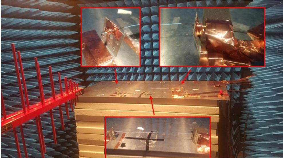
Figure 44 – Irradiation d'un fil au-dessus d'un plan de masse
