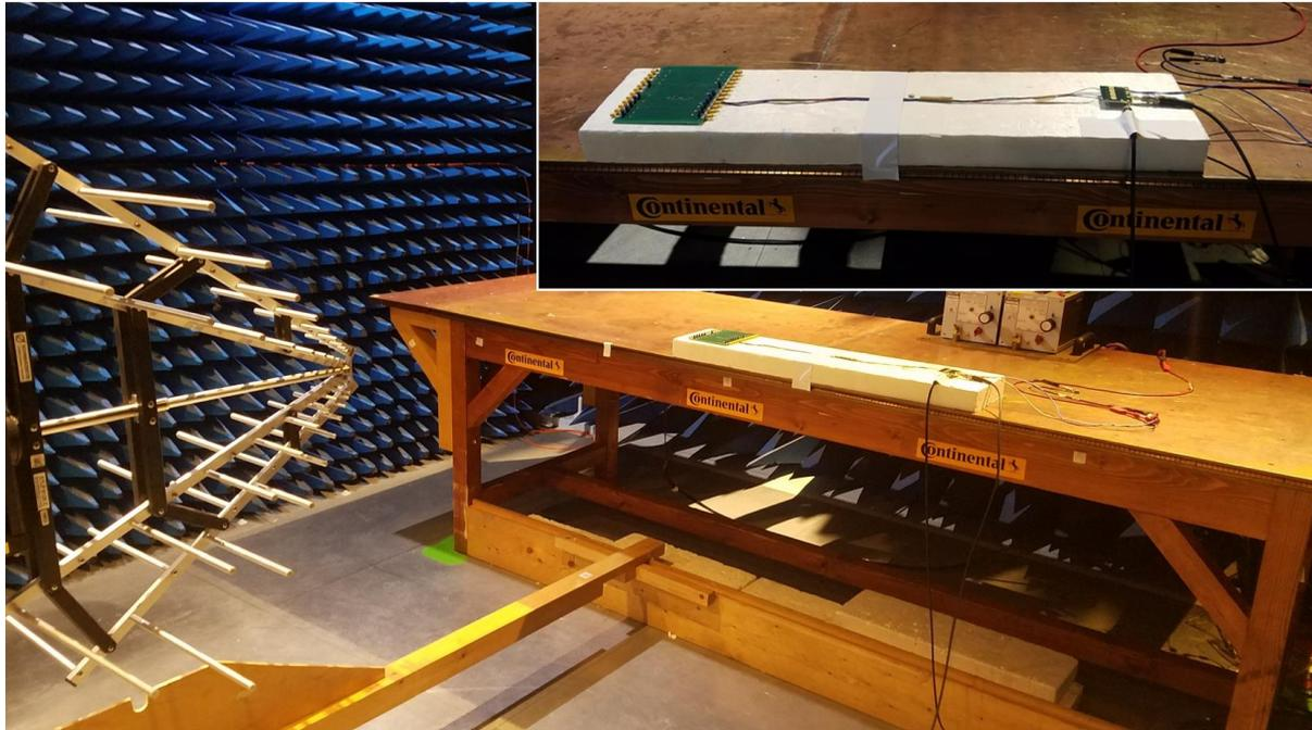
Figure 169 – Configuration de l'essai RI du capteur de courant en polarisation verticale
