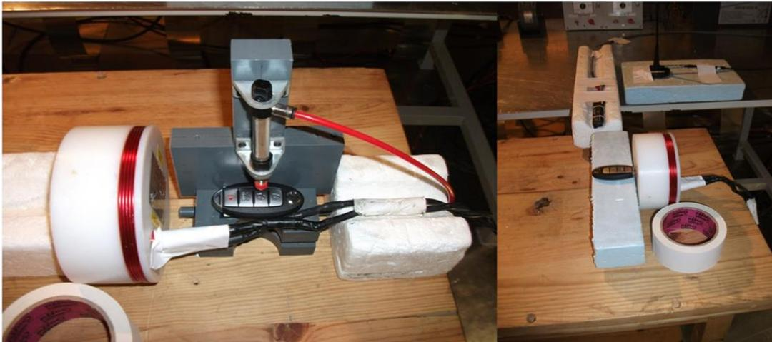
Figure 18 – Configuration d'un essai en immunité aux champs magnétiques (Sources ISO, Excentech, Continental)
