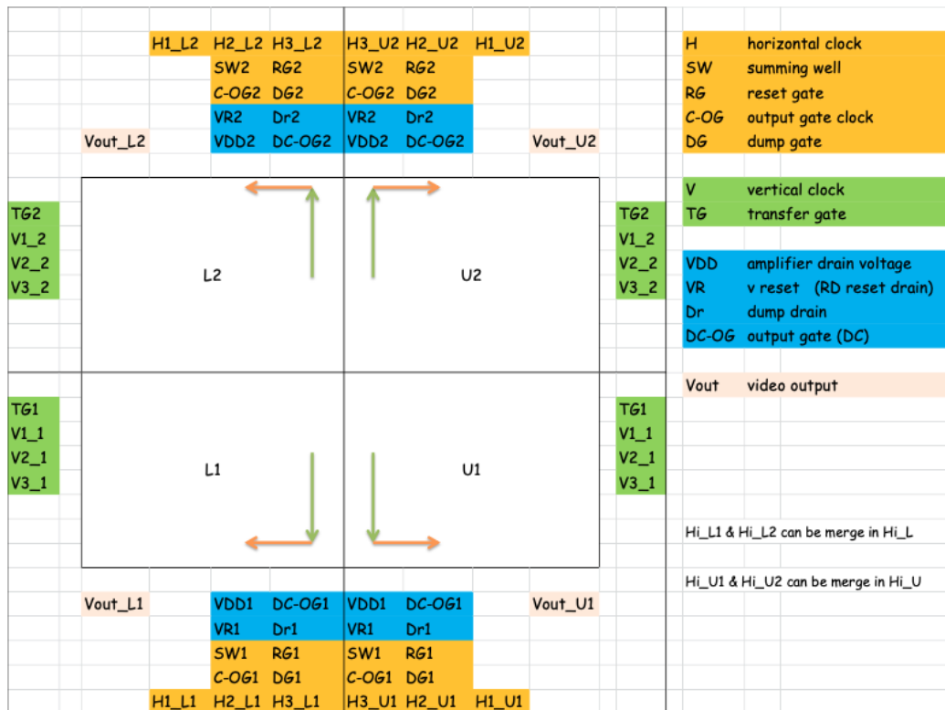
FIGURE 2.13 – Architecture du CCD qui montre les quatre régions de lecture (les quatre amplificateurs de lecture) U1, U2, L1 et L2 ainsi tous les horloges et les tensions de polarisation nécessaires pour piloter un Skipper CCD 6k x 6k
