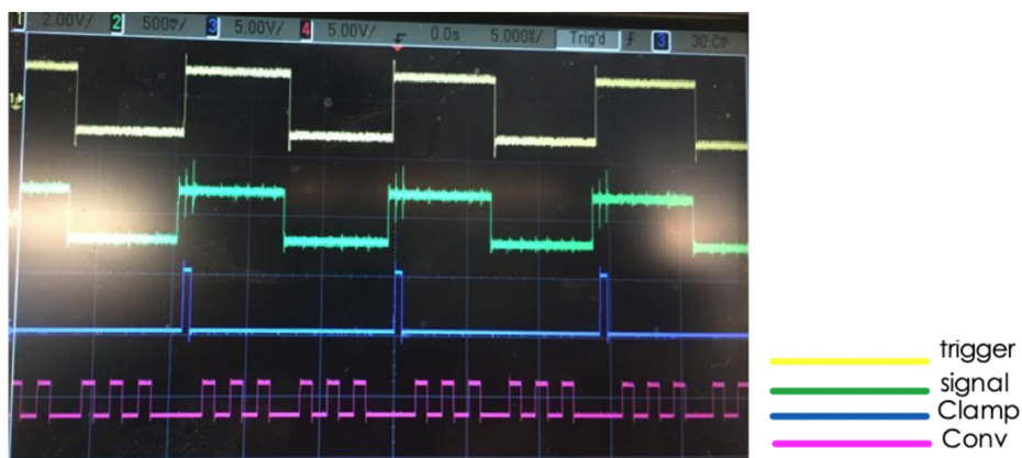
FIGURE 5.3 – le séquençage des horloges de l'acquisition de l'ASPIC
