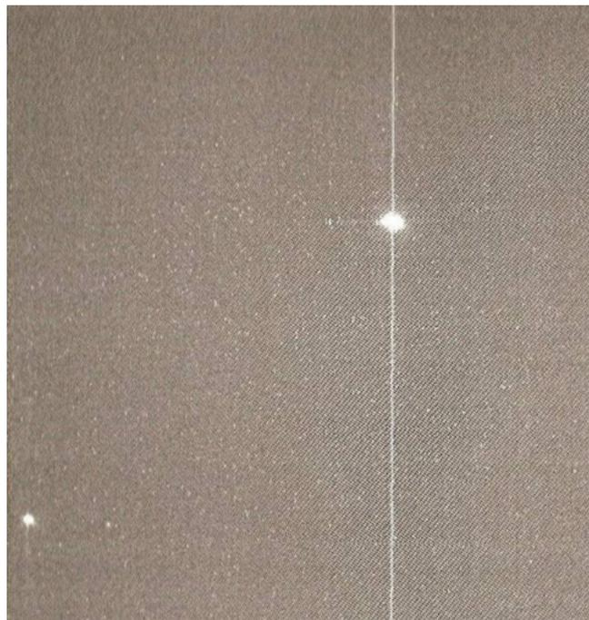
FIGURE 2.8 – image contenant une luminescence en deux pixels
