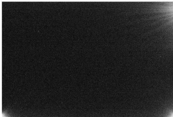
FIGURE 2.6 – luminescence d'amplificateur dans une image capturée par un CCD
