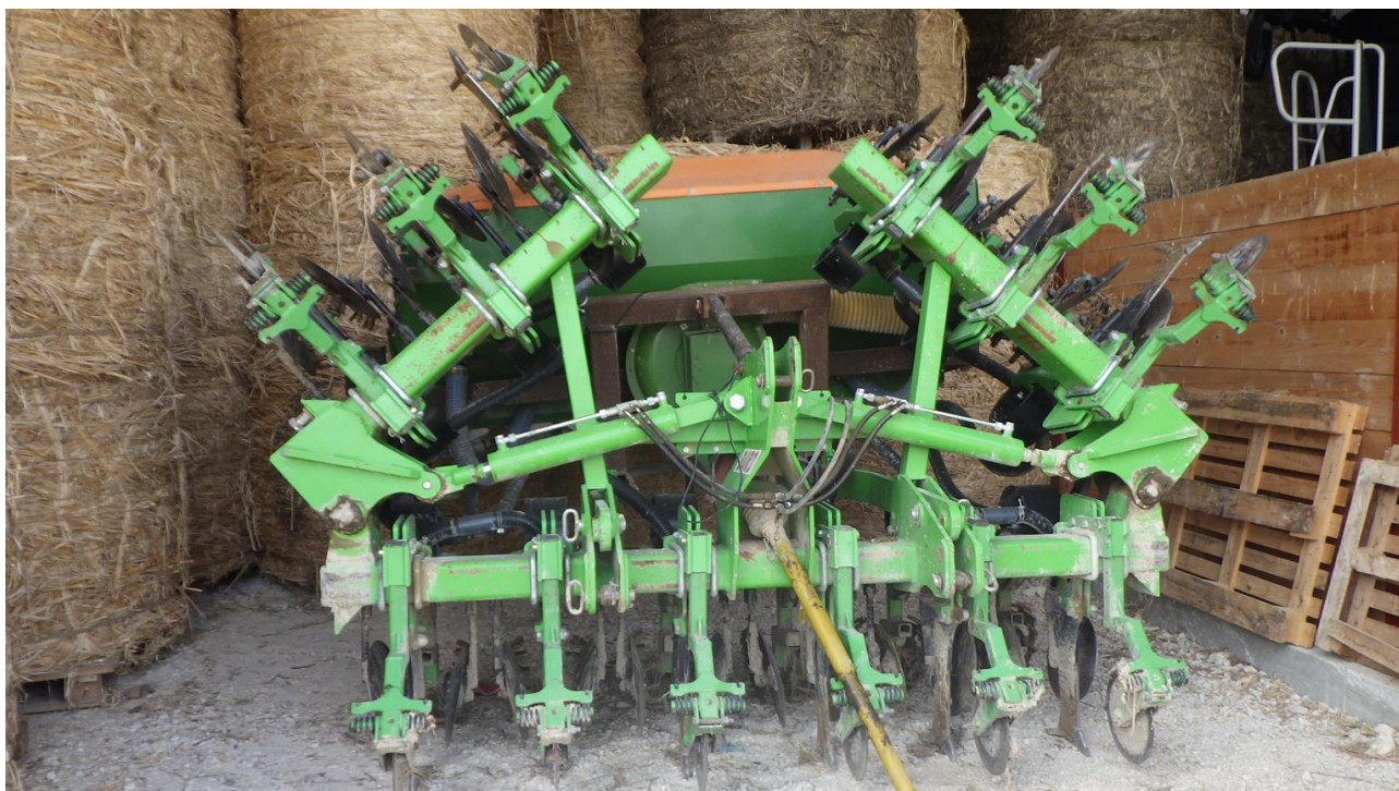
Photographie 8. Semoir de semis-direct (MA, avril 2019).
