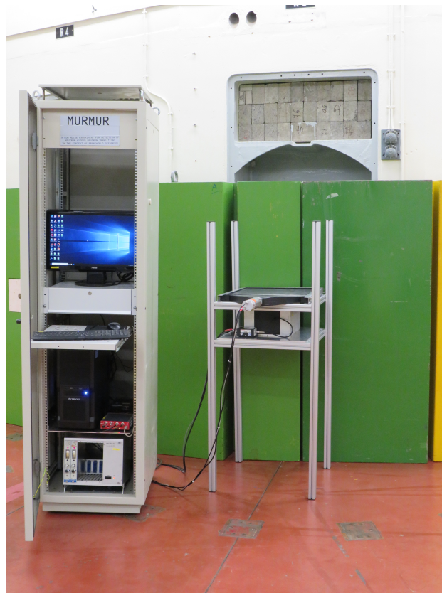
FIGURE 7.3 – Photographie de la seconde configuration de l'expérience MURMUR sur le site du BR2 à Mol en Belgique. Dans cette géométrie, un blindage passif additionnel sous forme de paraffine de 40 cm d'épaisseur a été ajouté.
