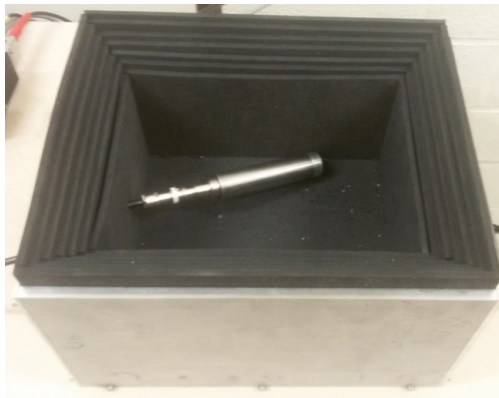
FIGURE 6.2 – Photographie du blindage fait de FLEXIBORE, un matériau composé d'un mélange de caoutchouc naturel et de poudre de carbure de bore ( \text{B}_4\text{C} ), fabriqué par l'entreprise BORFLEX en France. Le blindage est composé de 7 feuilles de 5 mm de FLEXIBORE assemblées en chicane, de façon à assurer l'étanchéité du blindage. Le blindage final possède une épaisseur de 3.6 cm.
