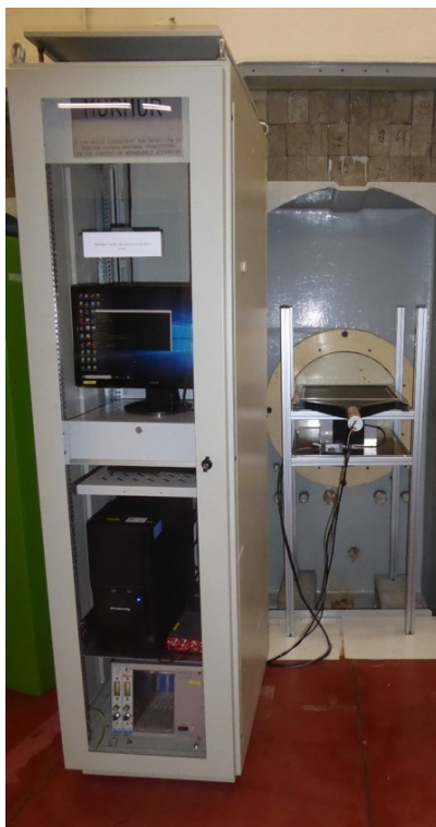
FIGURE 7.2 – Photographie de la première configuration de l'expérience MURMUR sur le site du BR2 à Mol en Belgique. Dans cette première géométrie, seule la boîte de 3.6 cm d'épaisseur en carbure de bore joue le rôle de blindage passif.
