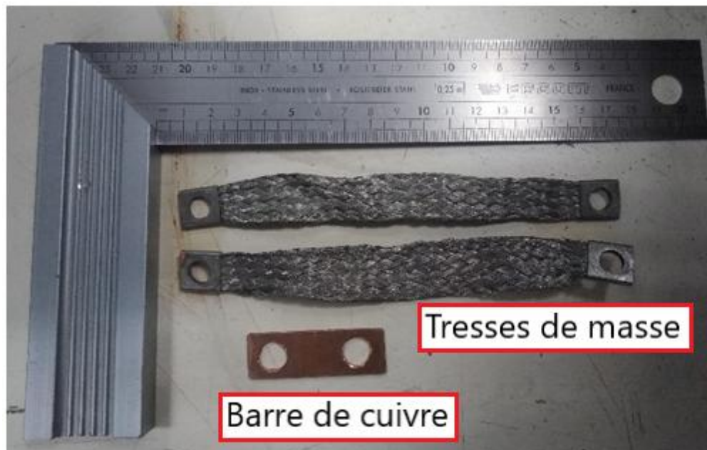
Figure 3.20 : Connectiques permettant de court-circuiter l'étage du bas en reliant les bornes de la phase et de la source du module de puissance MOSFET SiC CREE.
