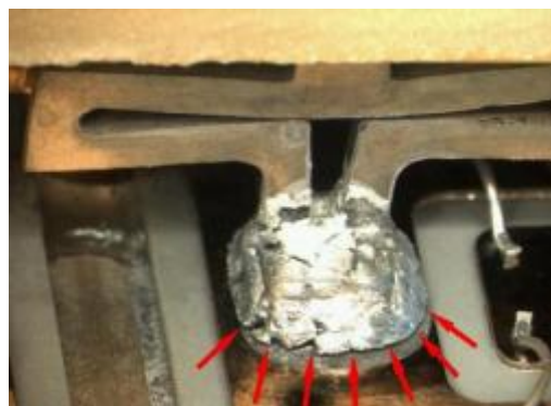
Figure 1.23 : Décollement de la soudure des connectiques de puissance dans un module.
