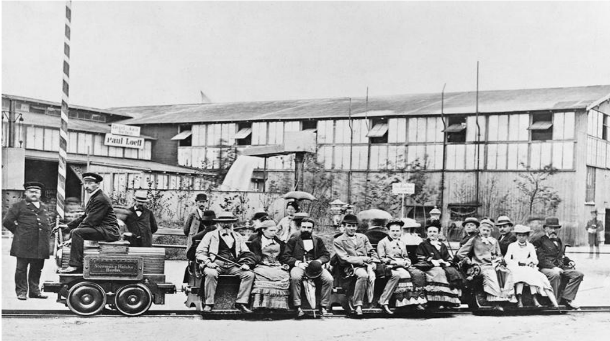
Figure 1.2 : Démonstration du train de Siemens et Halske à l'exposition de Berlin en 1879.
