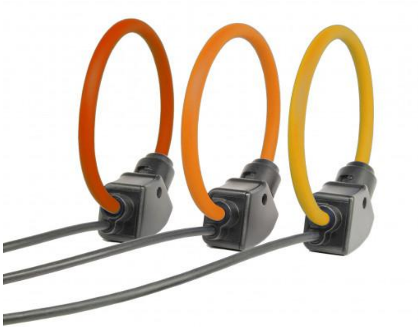
Figure 4.3 : Tores de Rogowski utilisés pour les mesures difficiles d'accès.
