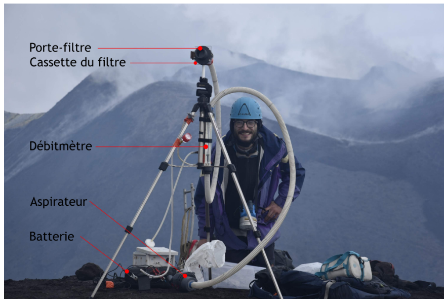
FIGURE 6.1 – Ligne utilisée pour le prélèvement de panache volcanique en vue de la mesure des descendants du radon.
