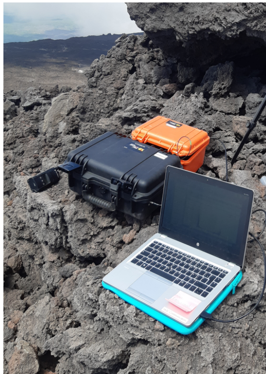
FIGURE 4.8 – Photographie de l’instrument RAVIOLI en cours de fonctionnement au sommet de l’Etna (août 2020). La valise noire contient les détecteurs et la valise orange contient la carte de traitement du signal.
