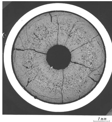
FIGURE I.6 – Coupe métallographique transversale d’une pastille de combustible RNR-Na
