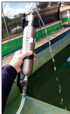
Fotografia 1 : Enchimento dos frascos cilíndricos de aço na posição vertical (análise dos CFC e SF 6 )
