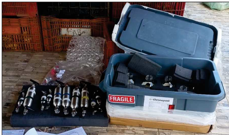
Fotografia 2: material utilizado para a amostragem dos gases dissolvidos (CFC, SF 6 , gases nobres)
