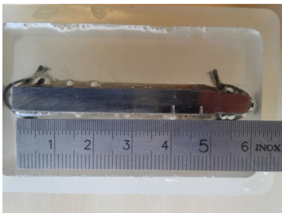
Figure 2.12 – Section transversale de l'éprouvette (substrat + 5 dépôts) extraite au milieu de l'éprouvette (section b sur la figure 2.13).
