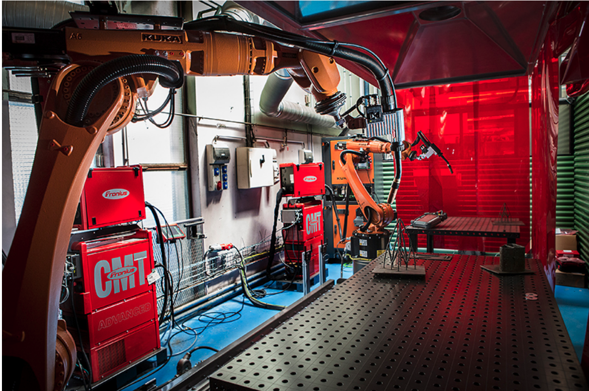
Figure 1.2 – Installation robotisée WAAM située sur le site de l'IUT de Nîmes
