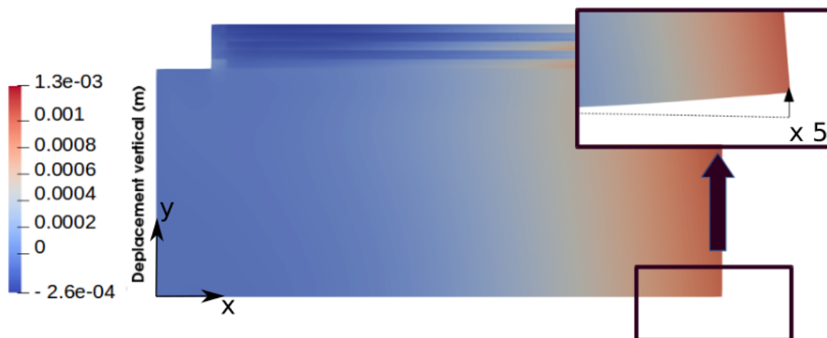
Figure 4.16 – Déformée de l'éprouvette après retour à température ambiante avec une focalisation sur la déformation observée au niveau du point de mesure (facteur d'échelle \times 5 ).
