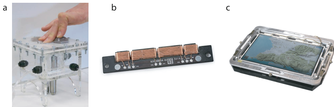
FIGURE 2.10 – a. Interface à surface déformable sur le concept de poches à air comprimé, issu de (Stanley et al., 2013), b. Actuateur vibrotactile du MacBook d'Apple™ (source www.ifixit.com ), c. F.O.I.L., interface à modulation de frottement par ondes ultrasonores avec un écran, issu de (Huloux et al., 2018b).
