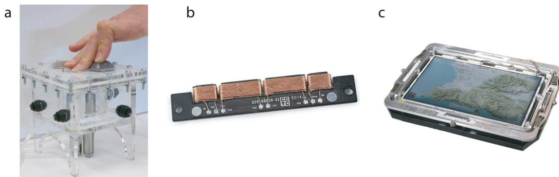
FIGURE 2.10 – **a.** Interface à surface déformable sur le concept de poches à air comprimé, issu de (Stanley et al., 2013), **b.** Actuateur vibrotactile du MacBook d'Apple™ (source [www.ifixit.com](http://www.ifixit.com)), **c.** F.O.I.L., interface à modulation de frottement par ondes ultrasonores avec un écran, issu de (Huloux et al., 2018b).
