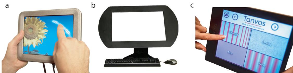
FIGURE 2.12 – **a.** TeslaTouch (Bau et al., 2010), **b.** Station de travail électroadhésive audio-tactile-visuelle (Shultz et al., 2017a), **c.** Tablette tactile Tanvas™.
