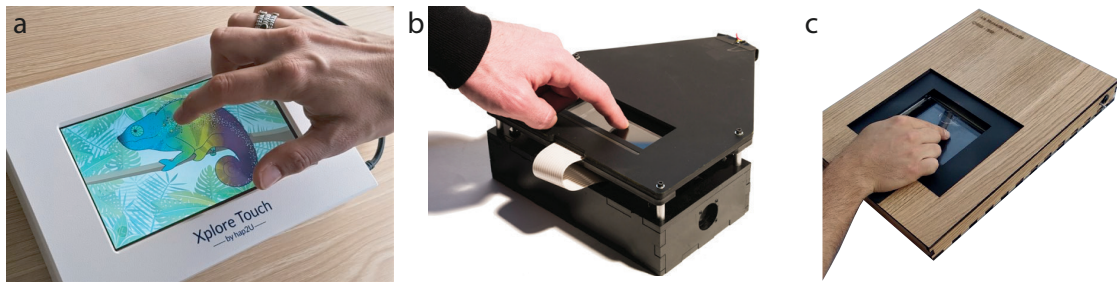
FIGURE 2.17 – a. Xplore de Hap2U™, b. Interface haptique à une dimension avec capteur de position optique issu de (Wiertlewski et al., 2014b), c. Interface haptique à deux dimension avec capteur de position optique issu de (Huloux et al., 2018a)
