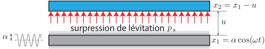
FIGURE 2.13 – Modèle du squeeze-film entre une plaque vibrante et une autre libre.
