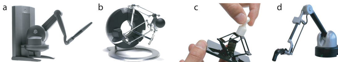
FIGURE 2.6 – Interfaces de téléopération commercialisées : a. Touch X, 3D Systems, b. Omega 3, Force Dimension, c. Foldaway Haptics d. Virtuoso 6D, Haption
