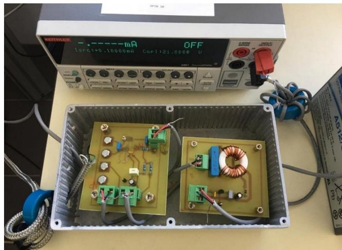
FIGURE 4.25 – Circuit de mesure de température par la sonde Pt100
