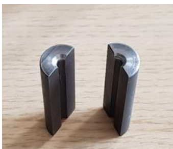
Figure 2-20 : Demi-cylindres alésés utilisés pour la tenue de l'éprouvette de fatigue dans les mors hydrauliques
