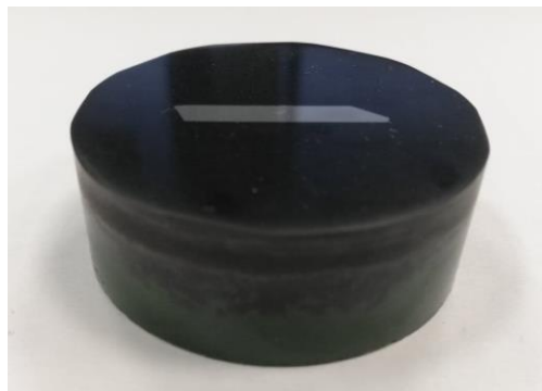
Figure 2-5 : Echantillon enrobé et poli
