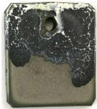
Figure IV-12 : Etat de dégradation d'un substrat Zr702 revêtu par 7 \mu\text{m} de \text{Cr}_2\text{AlC} après oxydation isotherme à 1100°C pendant 60 min suivi d'une trempe à l'eau.
