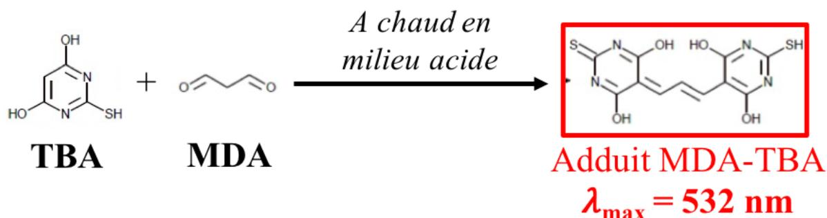
Figure 141 – Principe de la réaction du dosage TBARS
