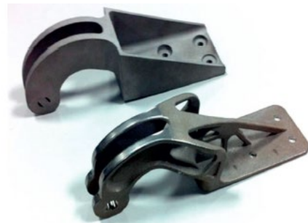
Figure 13 - Charnières de nacelle de turboréacteur d'avion. Au-dessus, charnière fabriquée par un procédé traditionnel. En dessous, charnière fabriquée par fusion laser sur lit de poudre en acier inoxydable. La pièce a été optimisée de manière à réduire sa masse tout en conservant ses propriétés mécaniques (EADS)
