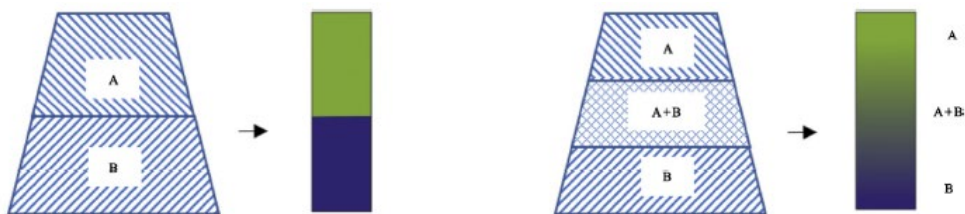
Figure 47 - Multi-matériaux conventionnel (à gauche), Matériau à gradient fonctionnel de propriétés (à droite). A et B sont des matériaux différents. [81]
