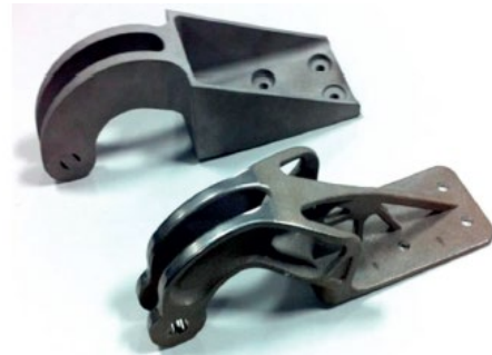
Figure 13 - Charnières de nacelle de turboréacteur d'avion. Au-dessus, charnière fabriquée par un procédé traditionnel. En dessous, charnière fabriquée par fusion laser sur lit de poudre en acier inoxydable. La pièce a été optimisée de manière à réduire sa masse tout en conservant ses propriétés mécaniques (EADS)
