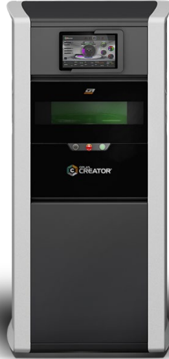
Figure 68 - Machine CREATOR (Coherent - ORLaser) de fusion de lit de poudre par faisceau laser utilisée pour comparer les résultats avec ceux des pièces obtenues sur la machine de 3D Systems.
