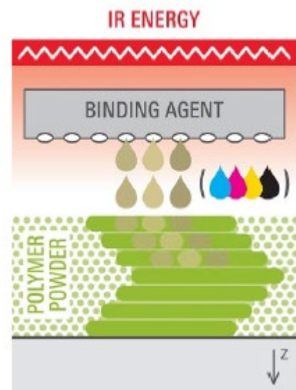
Figure 31 - Schéma de principe de la fusion sur lit de poudres polymères par lampe IR et projection d'absorbants IR et de liants pigmentés [47]
