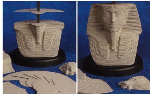
Figure 11 – Illustration de la fabrication additive par l'empilement successif des sections/couches permettant d'obtenir une maquette réelle sous la forme d'un portrait de pharaon (Hasbro-MB puzzle)
