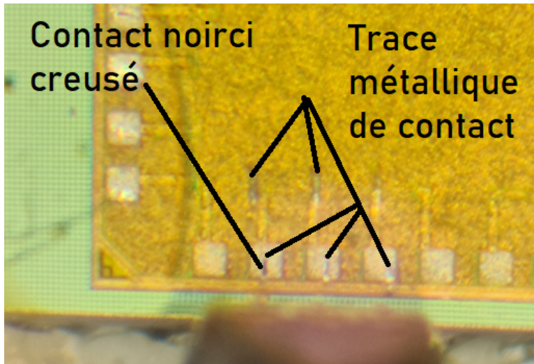
FIGURE 112 – Photographie de la pose des sondes sur le pad métallique
