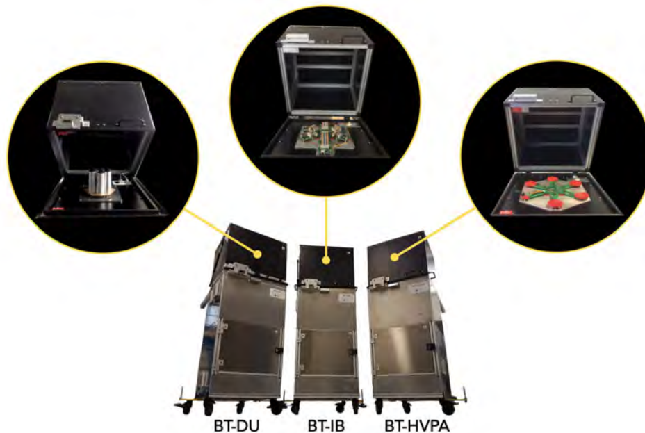
FIGURE 2.16 – Photo des 3 bancs de test — de gauche à droite le banc DU, IB et HVPA — L x l x h : 0,7 × 0,7 × 1,2 m (©photo C. Marty, A. Tsiahina, propriété IRAP-Microtec).
