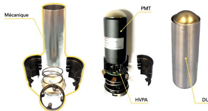
FIGURE 2.13 – Le Detector Unit (DU) version v4 — \varnothing \times L : 4,96 \times 13,95 cm — poids : 152 g (©photo A. Tsiachina, IRAP).
