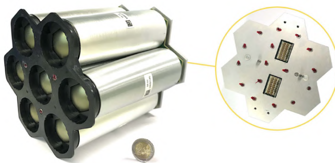
FIGURE 2.8 – Le Focal Plane Module (FPM) version v2 — L x l x h : 15,9 × 14,4 × 14,4 cm — poids : 1309 g — consommation nominale : \sim 150 mA (©photo A. Tsiachina, IRAP).
