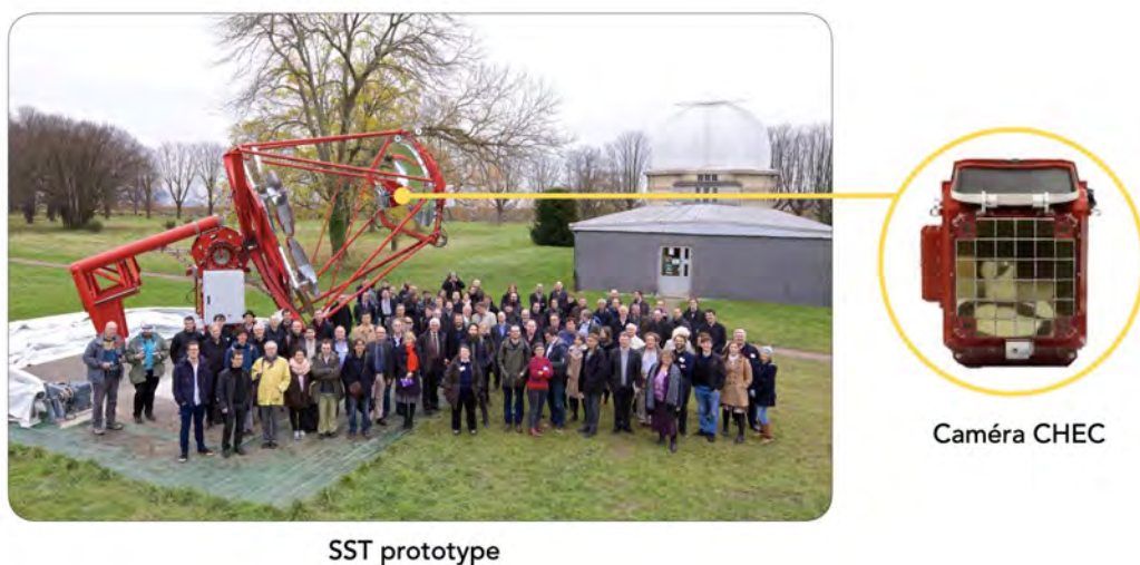
FIGURE 1.27 – La caméra Compact High Energy Camera (CHEC) — type de photodétecteur : SiPM, (©CTA GCT project) montée sur le SST prototype — \varnothing : 4,3 m — poids total avec caméra : 19 T (©Akira Okumura).
