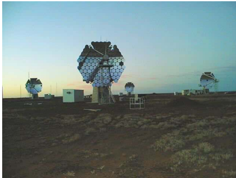
FIGURE 1.15 – Entre 2000 et 2003, quatre télescopes gamma CANGAROO-III de 10 m ont été construits à Woomera (Australie) ©photo CANGAROO project.
