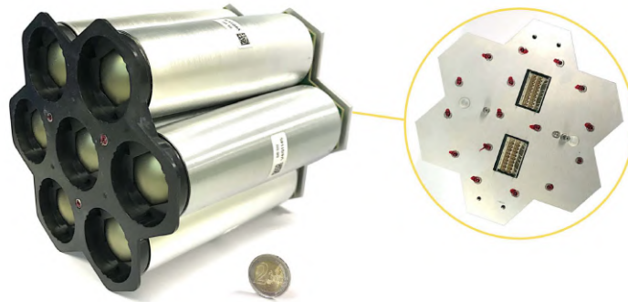
FIGURE 2.8 – Le Focal Plane Module (FPM) version v2 — L x l x h : 15,9 × 14,4 × 14,4 cm — poids : 1309 g — consommation nominale : \sim 150 mA (©photo A. Tsiachina, IRAP).
