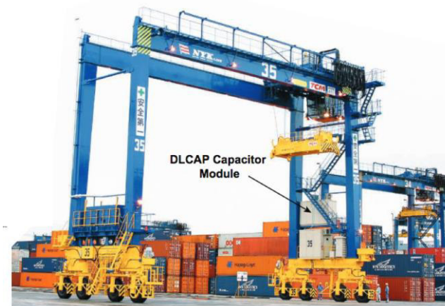
Figure 9 Grue portuaire combinant un moteur diesel et des modules de supercondensateurs [29].
