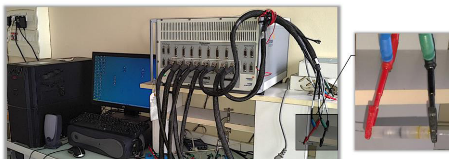
Figure 3 Potentiostat Solartron 8 voies utilisé pour la caractérisation électrochimique des supercondensateurs (CV, conditionnement), cellule électrochimique utilisée pour la RMN (droite) branchée en montage deux électrodes pour la caractérisation.
