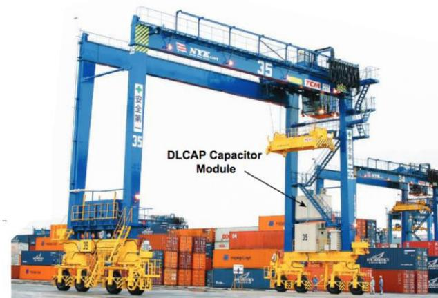
*Figure 9 Grue portuaire combinant un moteur diesel et des modules de supercondensateurs [29].*
