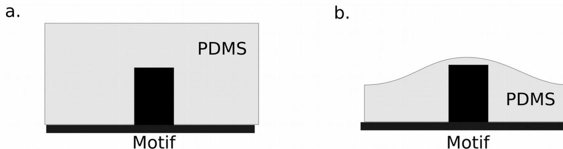
Figure 32: Configuration où la hauteur du PDMS n'est pas optimale. a. : Cas où la hauteur est trop grande et n'est pas déformable. b. : Cas où la hauteur est inférieure à la taille du motif et ne permet pas une liaison correcte avec la couche supérieure de flux.
