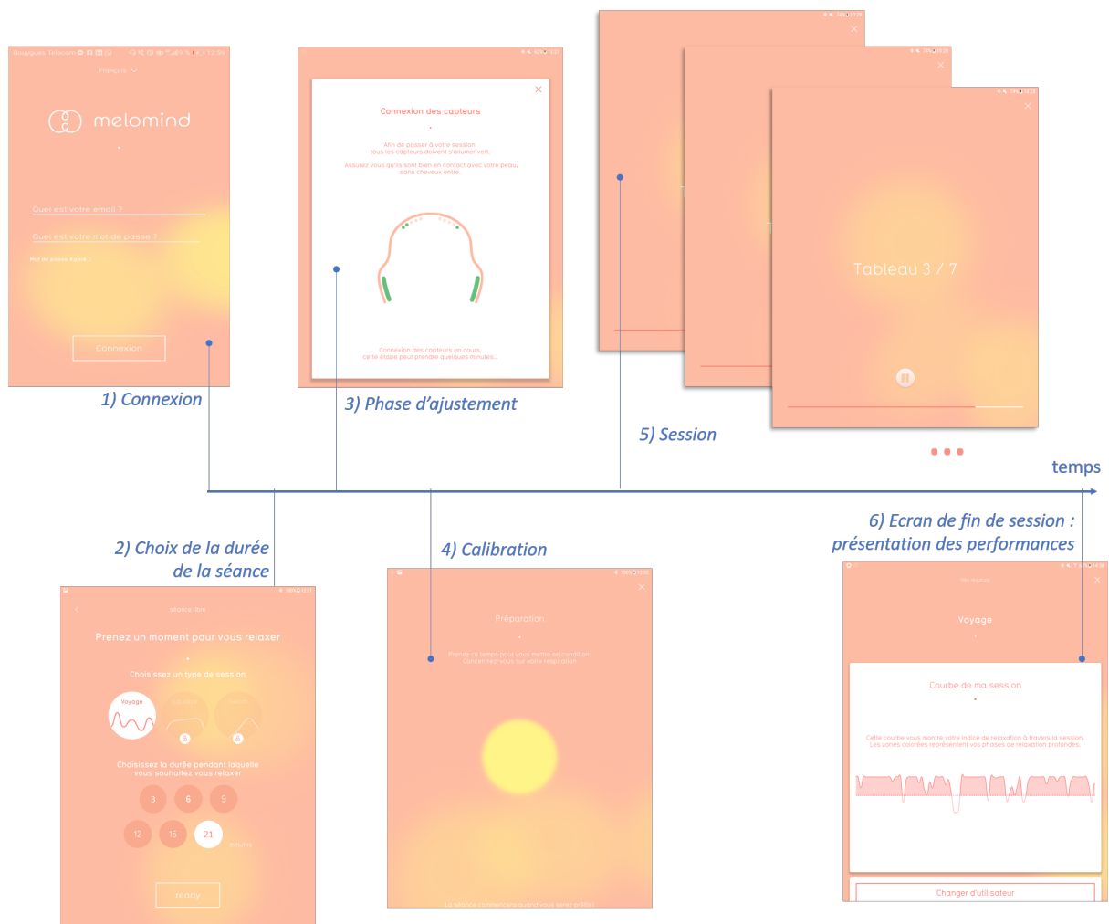
FIGURE 2.4 – Représentation chronologique des phases d’une séance type de neurofeedback melomind™ en 6 étapes : captures écran de l’application. 1) Connexion : l’utilisateur est invité à se connecter à son compte, puis 2) à choisir la durée de sa séance. Une fois le casque mis en place, l’application procède à 3) la phase d’ajustement afin de vérifier la bonne qualité des signaux EEG reçus. Si la qualité des données mesurées est suffisante (voir Chapitre 4), l’application procède à une 4) calibration de 30 secondes, durant laquelle diverses mesures seront effectuées (voir Chapitre 6). 5) La session de neurofeedback, composée de plusieurs tableaux sonores (aussi nommés exercices) de 3 minutes chacun, est ensuite lancée. 6) Enfin, une courbe retraçant les performances de modulation de l’INF au cours de la session est présentée à l’utilisateur. L’échelle temporelle n’est pas représentative des durées réelles.
