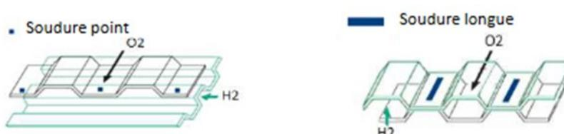
Figure 2-16 Représentation schématique des soudures « point » et « longue » sur la plaque bipolaire.
