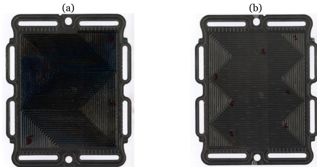
*Figure 2-25 Scans des plaques bipolaires revêtues TiC par PVD vieilles en pile, a) côté cathodique, b) côté anodique.*
