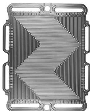
Figure 2-5 Plaque bipolaire en acier inoxydable 316L revêtue céramique Max Phase [66].
