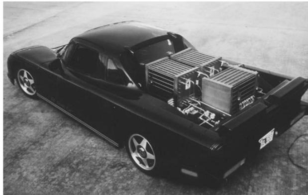
Figure 1-4 Première voiture fonctionnant avec pile à combustible à membrane échangeuse de proton, nommée « Green Car ».
