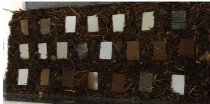
Figure 38 : Dépôt des échantillons sur la première couche de compost.
