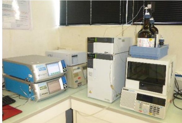
Figure 41 : SEC-chloroforme utilisée lors des essais.
