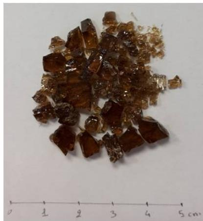
Figure 2.1 : Laitier industriel refondu au laboratoire
