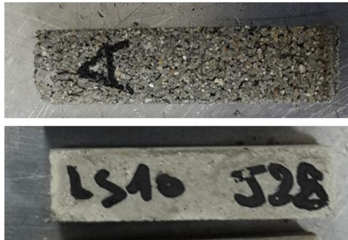
Figure 7.3 : Micro-mortiers de 1x1x4 cm<sup>3</sup> réalisés avec des proportions ciment:sable:eau de 1:3:0,5 (en haut) et 1:2:0,6 (en bas).
