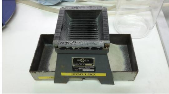
Figure 7.2 : Le sable micro-barre est quarté avec un séparateur à lames.
