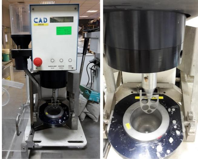
Figure 7.4 : Malaxeur utilisé pour le gâchage des micro-mortiers.
