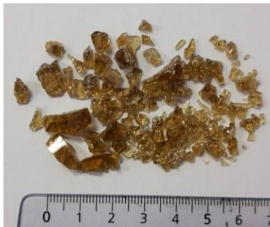
Figure 2.2 : Laitier modèle synthétisé au laboratoire
