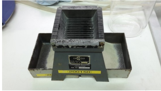
Figure 7.2 : Le sable micro-barre est quarté avec un séparateur à lames.
