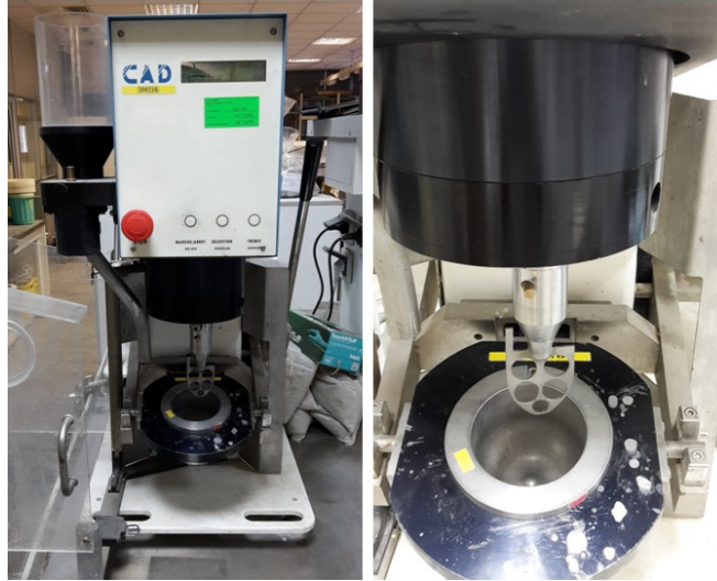
Figure 7.4 : Malaxeur utilisé pour le gâchage des micro-mortiers.
