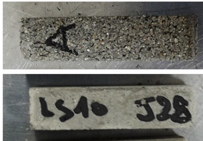
Figure 7.3 : Micro-mortiers de 1x1x4 cm 3 réalisés avec des proportions ciment:sable:eau de 1:3:0,5 (en haut) et 1:2:0,6 (en bas).
