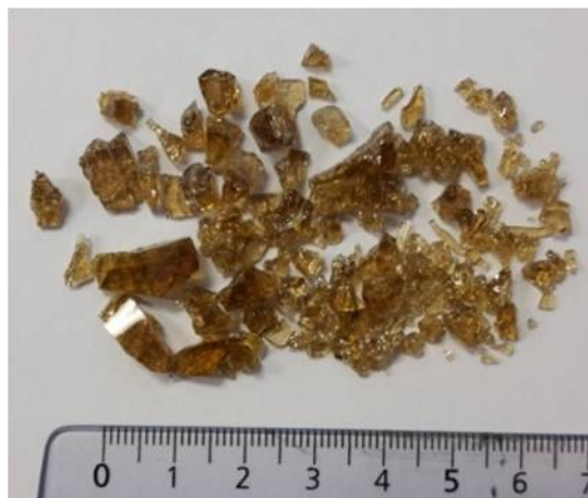
Figure 2.2 : Laitier modèle synthétisé au laboratoire
