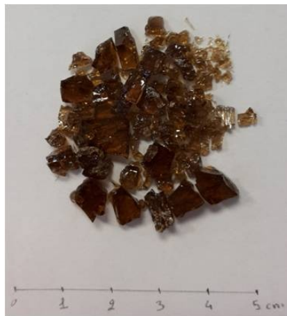
Figure 2.1 : Laitier industriel refondu au laboratoire
