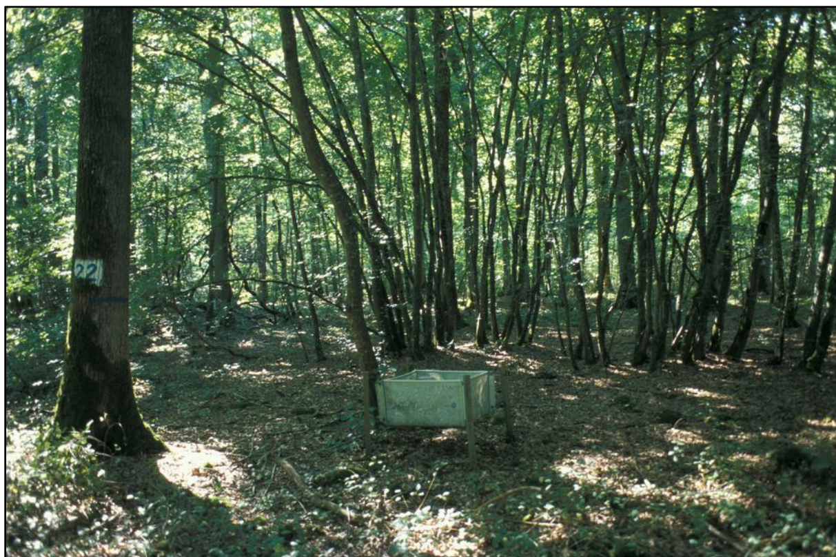
Image 7 : Collecteur de litière, installé sur une placette d’observation RENECOFOR dans la forêt domaniale de Larivour (Photographie de Luc Croisé 106 )
