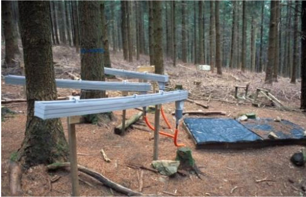
Image 9 : Gouttières et totalisateurs sous couvert forestier (Photographie de Luc Croisé)
