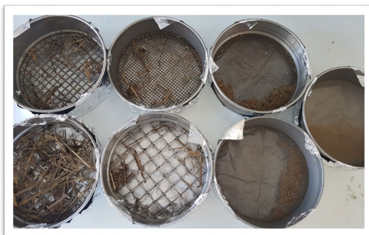
Figure 2—1. Tamis utilisés pour la mesure de la distribution de taille de particules. Substrat : Fumiers bovins.
