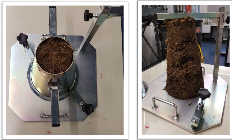
Figure 2—4. Essais d’effondrement avec le cône d’Abrams. Substrat : fumiers bovins.
