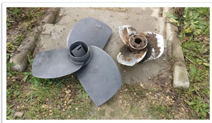
Figure 3—20. Diamètre de la pale d'agitation (inox) après 3 ans de fonctionnement sur un fumier non broyé. Le diamètre a été divisé par deux (Photo : Pacaud, S., Domaine expérimental de La Bouzule).
