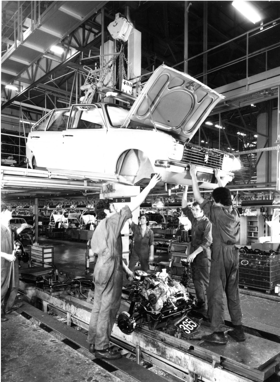
Photo 4 : Production d'une Peugeot 104, « descente » de caisse au montage dans les années 1970. Dans des ateliers encore peu mécanisés, le « travail vivant » est encore au centre du processus de production. Sans date (source : archives municipales de la ville de Mulhouse).
