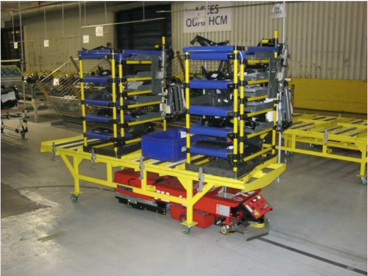
Photo 2 : AGV (en rouge) transportant des kits (en jaune et bleu). Nous pouvons apprécier également la bande magnétique placée au sol (source : CHSCT montage, Réunion extraordinaire du 24 octobre 2016).
