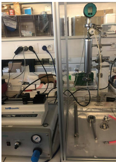
Figure 15 : Montage de l'unité d'encapsulation Nisco Var J30.
