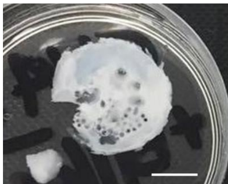
Figure 12 : Photo de la matrice CollGlass1. La présence de billes est visible au sein de la matrice (barre d'échelle = 0,5 cm).
