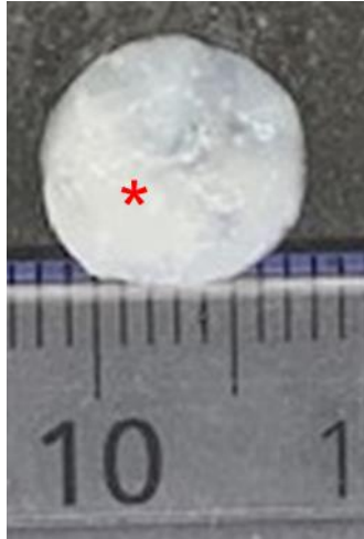
Figure 12 : Photo de la matrice collagène-glycérol 50/50 (40 mg/mL). La présence d'agglomérats est notée par une *.
