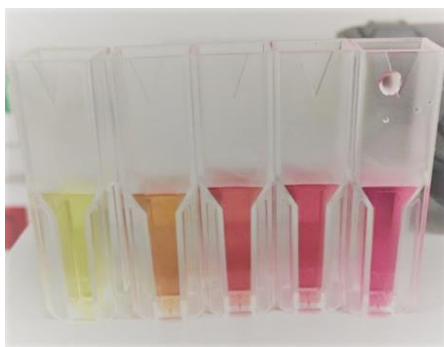
Figure 3 : Gamme d'étalonnage d'hydroxyproline.
