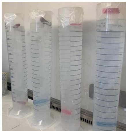
Figure 2 : Dialyse du collagène contre l'acide acétique 0,5 M.
