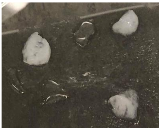
Figure 16 : Photo macro de la matrice CollCocoM-30-70-6,5%. Des pores sont visibles au sein de la matrice.
