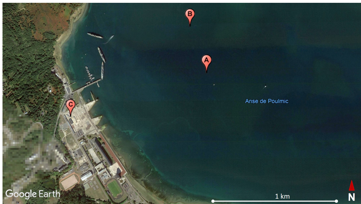
FIGURE 4.1 – Vue aérienne de l'École navale de Lanvéoc et positions des principaux éléments de l'expérimentation. A : plateforme d'essai en mer, sur laquelle est installé l'interrogateur optique ainsi que son système d'alimentation et de communication. B : sismomètre sous-marin constitué de 3 géophones de type L22 reconditionnés (cf. figure 4.2), et OBS Güralp. C : local de maintenance et sismomètre de référence TRILLIUM compact 120s.
