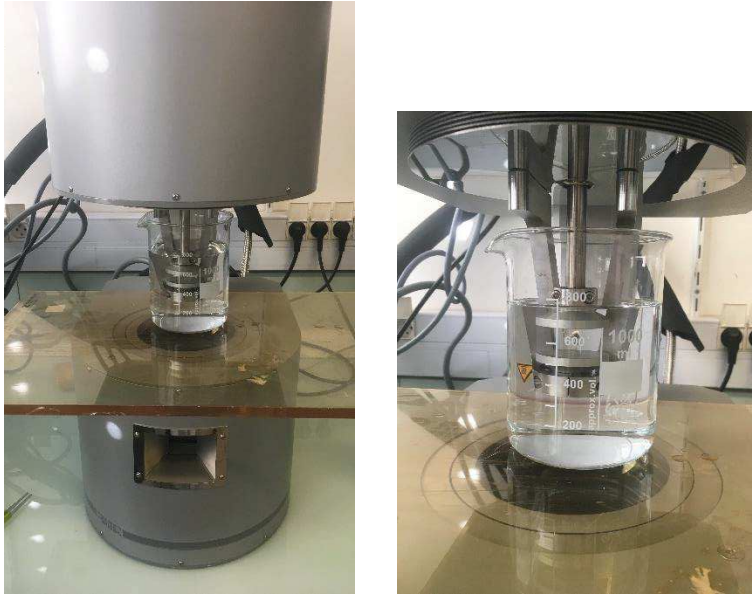
Figure 2-11 : Test de compression en immersion
