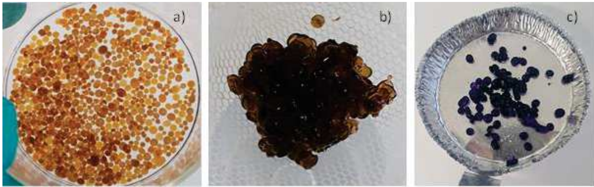
Figure 3-40 : Photographies des différents systèmes de catalyseurs : (a) billes de gélatine activées par greffage de la laccase de Trametes Versicolor (billes activées TvL ) (b) billes de gélatine avec de l'ABTS encapsulé (billes ABTS ) (c) billes de gélatine activées par une co-immobilisation ABTS/ TvL (billes activées TvL/ABTS )
