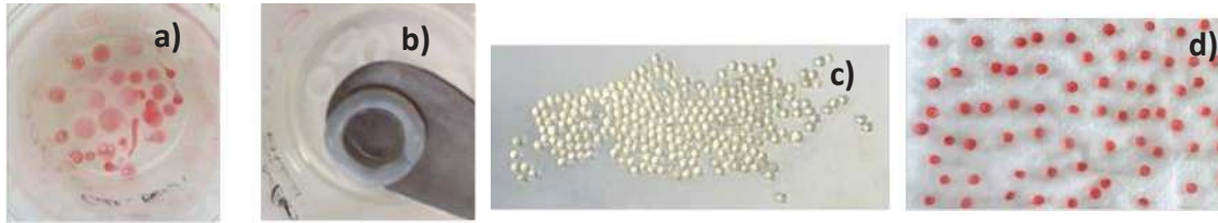
Figure 3-1 : Photographies des billes obtenues avec différents bain de coagulations ; (a) \text{CaCl}_2 , (b) éthanol ; (c) Huile de tournesol ; (d) \text{PEG}_{10} . Certaines billes ont été colorées avec un colorant alimentaire rouge pour faciliter leur observation.
