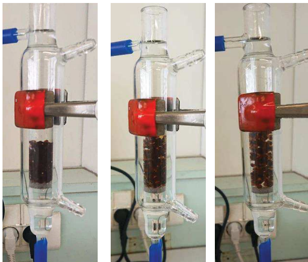
Figure 3-31 : Photos des billes activées dans le réacteur pour différents débits de recirculation (de gauche à droite : 30 \text{ mL.min}^{-1} ; 80 \text{ mL.min}^{-1} ; 130 \text{ mL.min}^{-1} )
