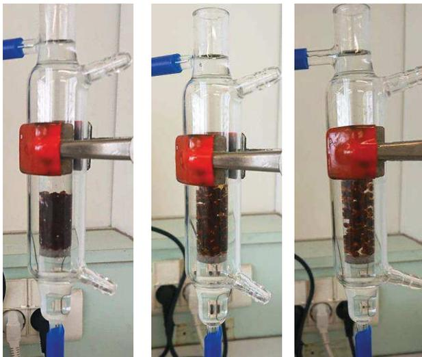
**Figure 3-31** : Photos des billes activées dans le réacteur pour différents débits de recirculation (de gauche à droite : 30 mL.min<sup>-1</sup>; 80 mL.min<sup>-1</sup>; 130 mL.min<sup>-1</sup>)
