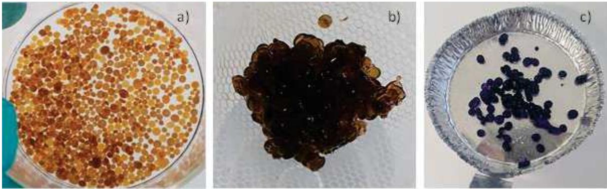
**Figure 3-40** : Photographies des différents systèmes de catalyseurs : (a) billes de gélatine activées par greffage de la laccase de *Trametes Versicolor* (billes activées  $TvL$ ) (b) billes de gélatine avec de l'ABTS encapsulé (billes<sub>ABTS</sub>) (c) billes de gélatine activées par une co-immobilisation ABTS/ $TvL$  (billes<sub>activées  $TvL/ABTS$</sub> )
