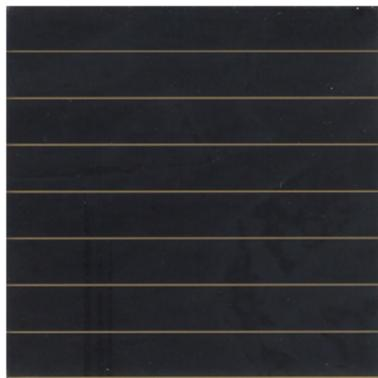
Figure 1.14 : Modules à base de cellules pérovskite stable, performante et ayant une surface de  $24,97 \text{ cm}^2$  fabriquée par Jung et coll. [48].
