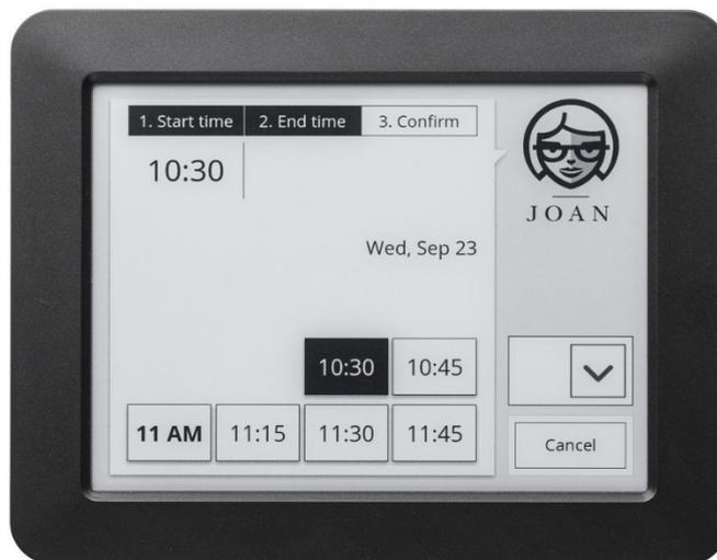
Figure 0.1 : La tablette Joan, communicante (Wifi), commercialisée par Visionect, permet d'afficher l'état de réservation de salle de réunion ou d'autres salles partagées. Équipée d'un écran à encre électronique, sa consommation de puissance électrique moyenne est de l'ordre d'une dizaine de milliwatts.
