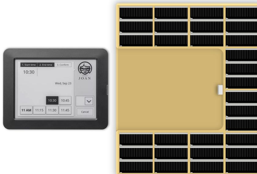
Figure 2.22 : Représentation d'un récupérateur d'énergie ayant une surface de récupération d'énergie d'environ 250 cm<sup>2</sup> et qui selon les expérimentations réalisées devrait suffire à rendre autonome la tablette d'affichage.
