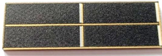
*Figure 1.12 : Module PV fabriqué par le groupe IXYS constitué de 4 cellules photovoltaïques en silicium monocristallin montées en série (dimensions : 43 mm x 14 mm ; surface : 6 cm<sup>2</sup>)*
