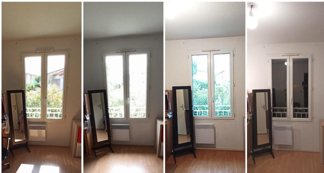
Figure 2.19 : Environnement de déploiement du prototype et du spectromètre pour l'expérimentation de validation du modèle de calcul. De gauche à droite : Période de très beau temps, ciel bleu, forte intensité lumineuse ; période de passage nuageux, luminosité diffuse ; période d'éclairage mixte naturel/artificiel ; période d'utilisation d'éclairage artificiel (nuit).
