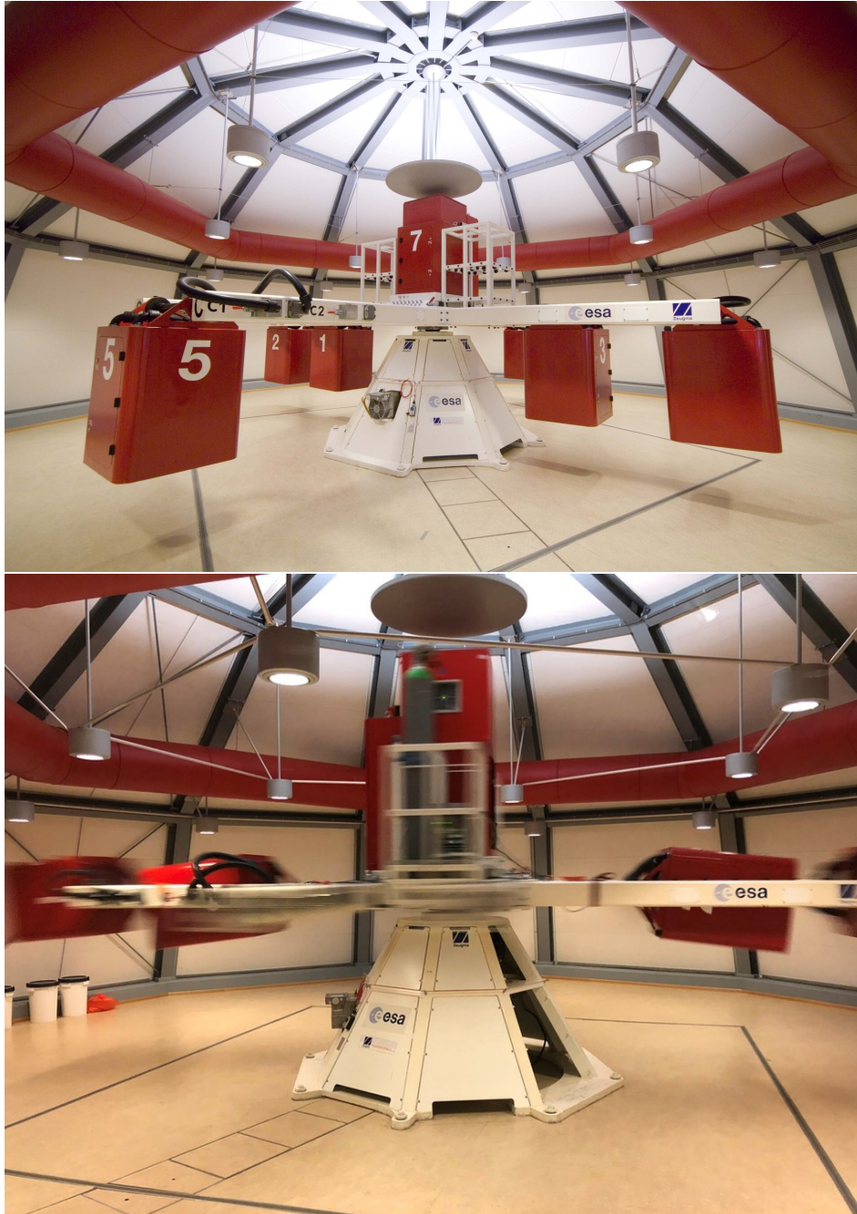
FIG. 4.2 Photographie de la LDC de l'ESA au repos (haut) en mouvement (bas), pour une gravité effective au fond de la gondole g^* \approx 20g
